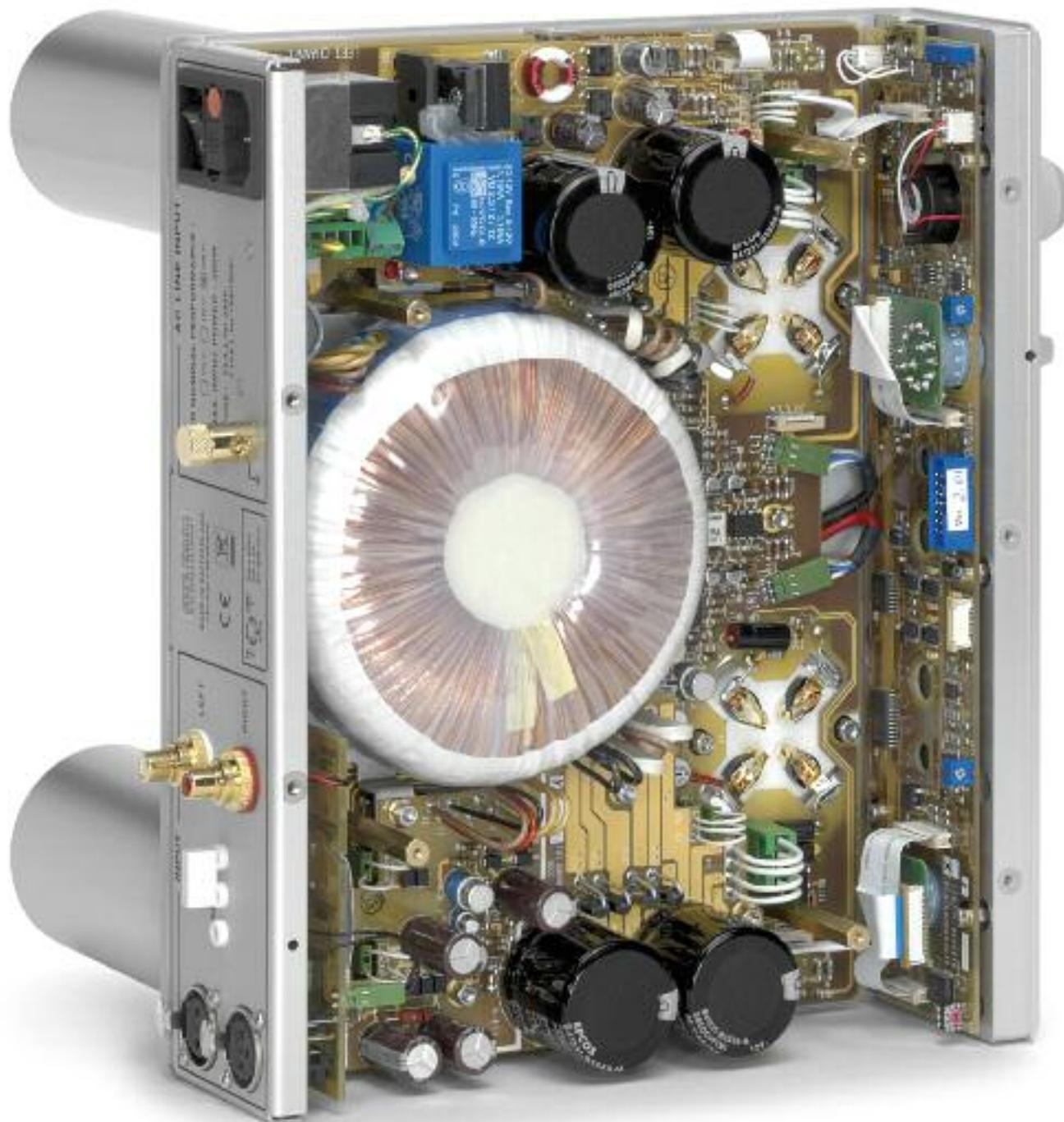
Ein großer Ringkern stellt 14 verschiedene Sekundärspannungen bereit, der kleine blaue Trafo dient dem Standby-Betrieb
