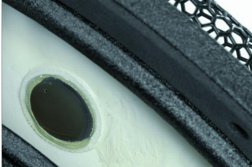
Laser-Operation: Zur Resonanzkontrolle werden aus der Mittelton-Membran zwei Löcher geschnitten und mit Kunststoff gefüllt
